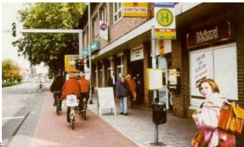
Рисунок 2. Оптимальное размещение велодорожки: а – отдельная полоса для движения велосипедистов; б – Германия, полоса выделена на тротуаре. Обратите внимание на то, что в любом случае потоки велосипедистов и пешеходов разделены.
